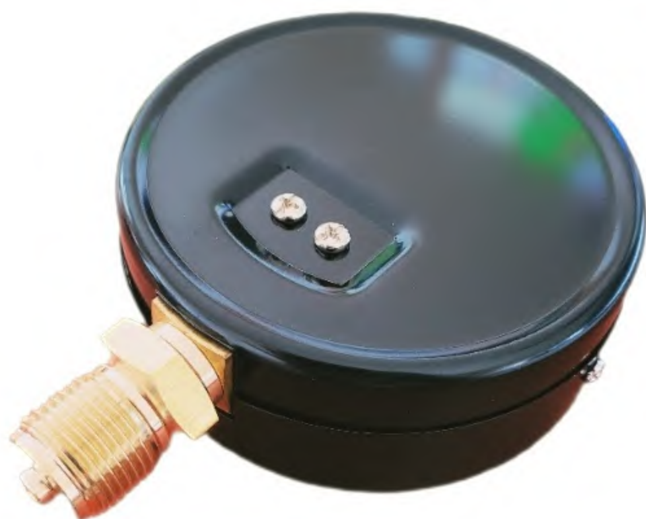
Manometr M100R; 0-16bar; kl. 1,6; G1/2" temp.maks.150'C 641U0097
